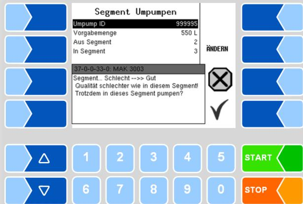
Das Zielsegment ist für Milch einer geringeren Qualität vorgesehen ist als die Milch aus dem Quellsegment. In diesem Fall wird die umgepumpte Milch auf die Qualität des Zielsegments abgewertet.
