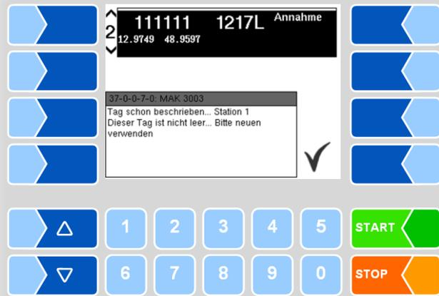
Der Tag konnte nicht erkannt werden. Prüfen Sie die Positionierung der Probeflasche bzw. tauschen Sie die Probeflasche aus.
