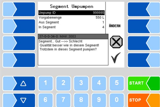
Nach Bestätigen der Eingaben startet der Umpumpvorgang. Die umgepumpte Menge wird gemessen, der Vorgang wird aufgezeichnet.
