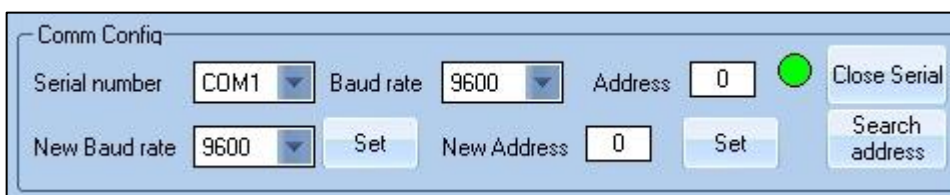
Abbildung 2 Programmbereich Comm Config, Kommunikation aktiv
