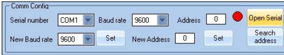
Abbildung 1 Programmbereich Comm Config, Kommunikation unterbrochen
